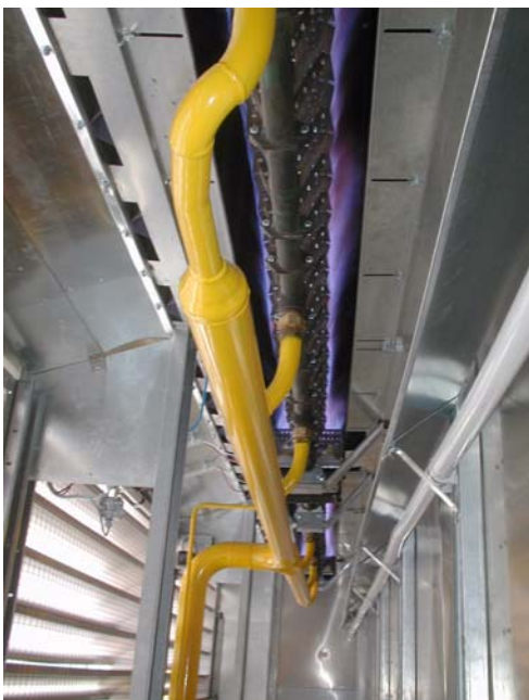
Chauffage d'air en direct avec des brûleurs NP- III AIRFLO® dans des sècheurs à flux continu pour le grain.
